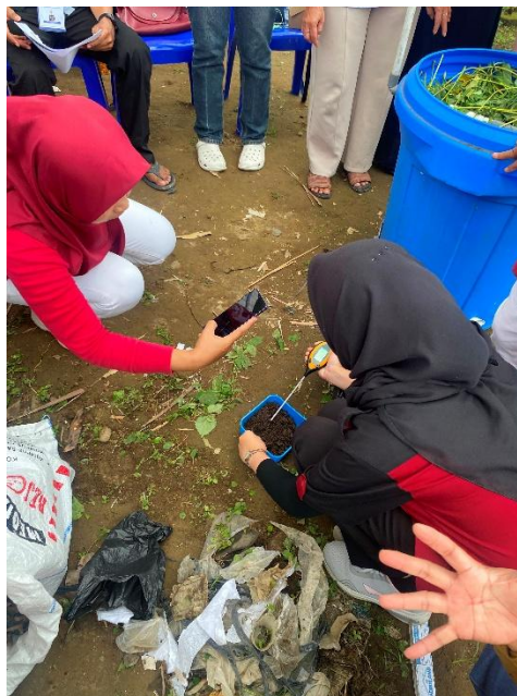
Gambar 2. Pengukuran kondisi Suhu dan PH bahan kompos menggunakan alat ukur digital.
